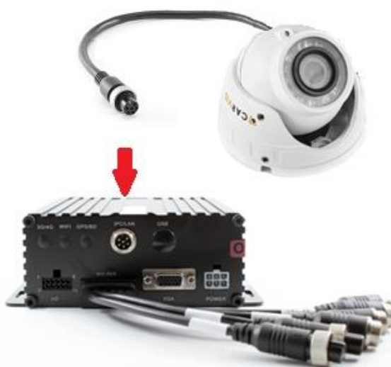
Рисунок 3 – Подключение камеры к автомобильному регистратору CARVIS
